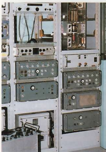
Kortegolfzender/ontvanger met antennenet- ner 1.5 - 29.999 MHz. 1955 1965.
